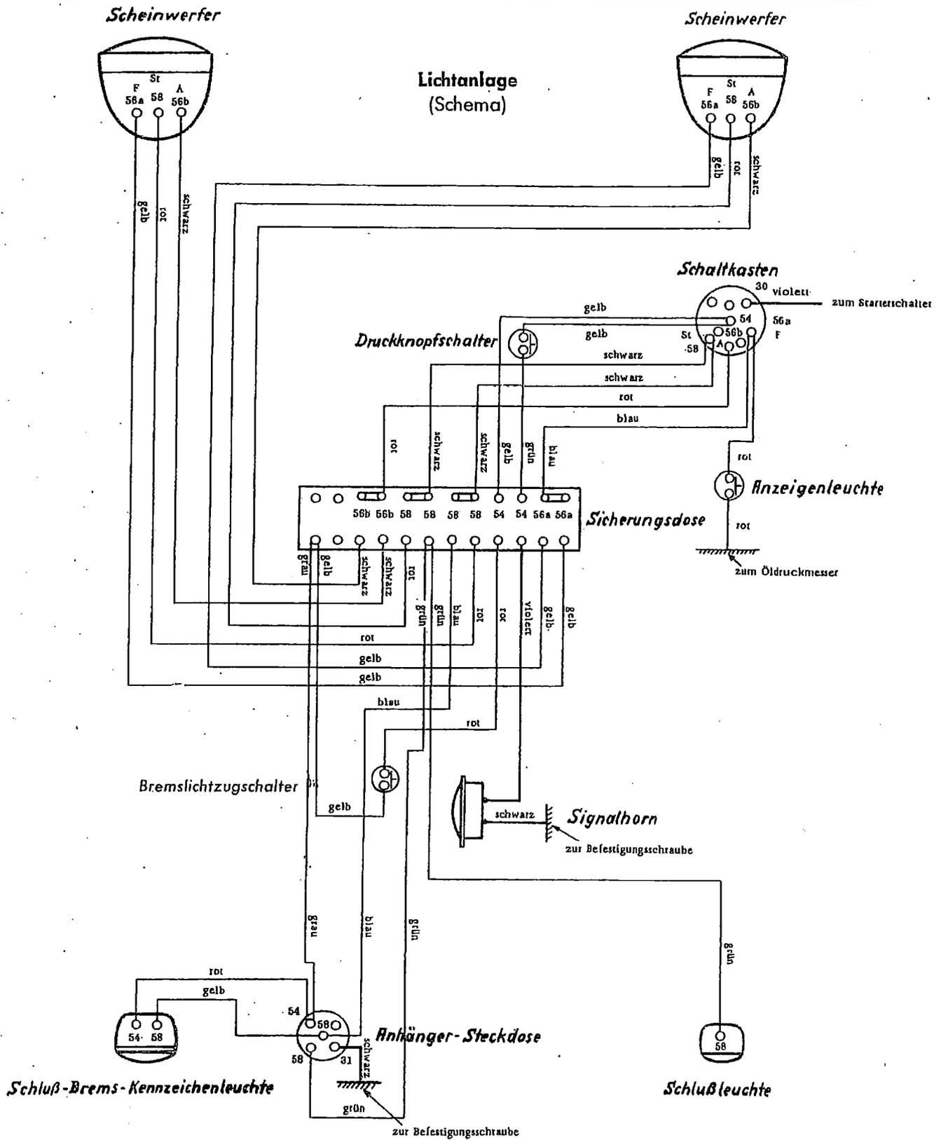
Gez. Kabelzuführung im Schaltkasten nach Bosch.
